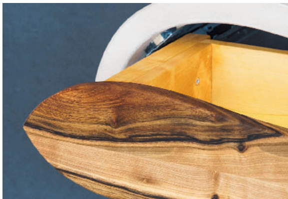
/ Der Schubkasten aus geölter Birke ist über schräg angesetzte Teleskopauszüge geführt. Der formverleimte Schubkastenboden folgt der Kontur des Vorderstückes aus Nussbaum.
